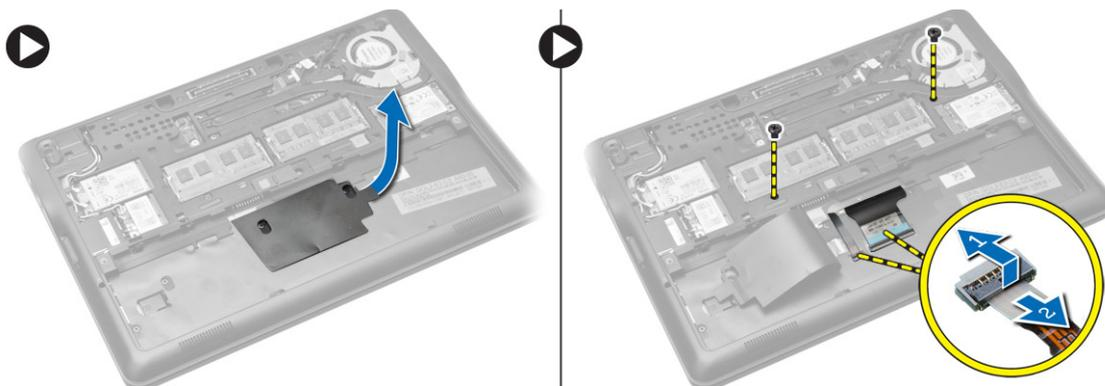
5. Vire o computador e remova os parafusos que prendem o teclado ao computador.
