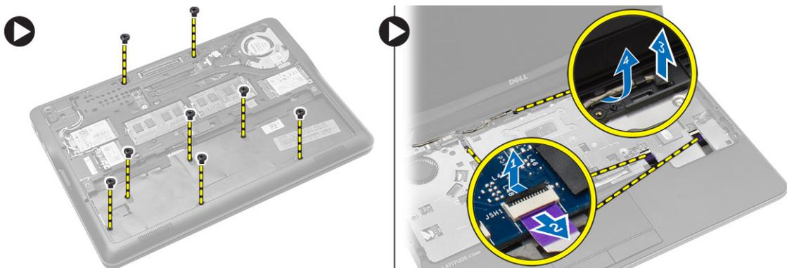
5. Remova os parafusos que prendem o conjunto do apoio para as mãos à parte frontal do computador. Retire as bordas e levante o conjunto do apoio para as mãos do computador.
